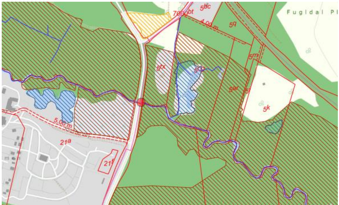
Figur 1: Krydsningspunkt (rød prik) under Skærså (kabel st. 1800) i vejmatrikel 7000p Siim By, Dover. Krydsningen sker via styret underboring. Det er en forudsætning at kabeltracéet ligger ml. vejkant og grøft så den beskyttede mose ikke påvirkes.
