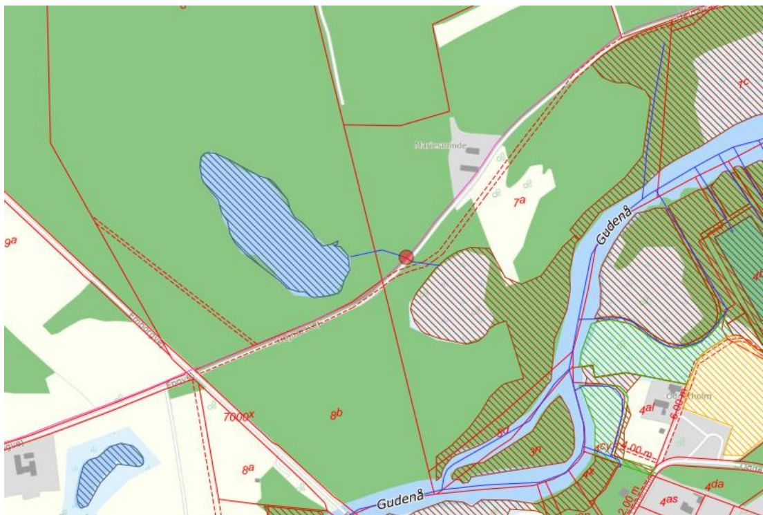
Figur 5: Krydsningspunkt (rød prik) over kanal ml. moseområde og vandhul (kabel st. 5800), Matr. 7a Gl. Rye By, Gl Rye. Krydsningen sker ved gravning.
