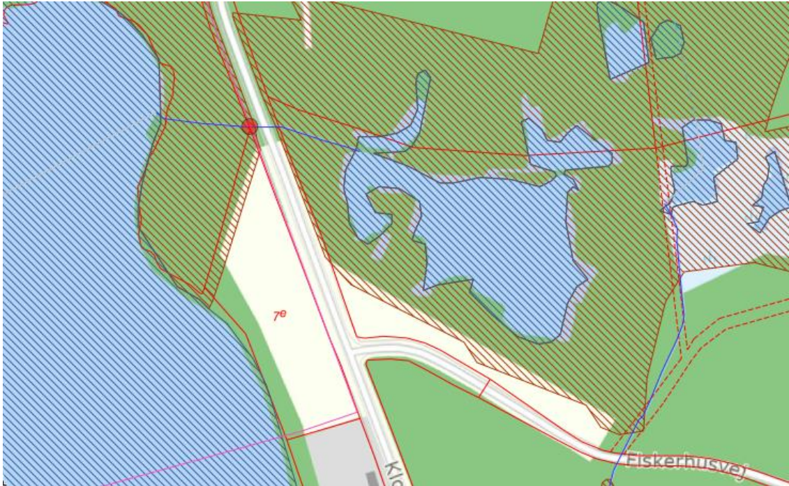
Figur 2: Krydsningspunkt (rød prik) under afløb fra vandområde/vandhul ml. Skærså og Gudenså (kabel st. 2250), krydsning sker i vejrabat matr. 7000b Emborg By, Gl Rye. Krydsningen skal ske ved styret underboring. Det er en forudsætning at tracéet ligger ml. vejkant og grøft og dermed ikke påvirker den beskyttede mose.
